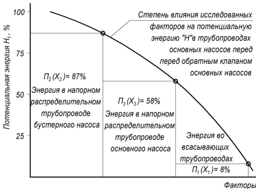
Рисунок 8 – Кривая зависимости степени влияния исследованных факторов на потенциальную энергию в напорном трубопроводе основного агрегата перед обратным клапаном
